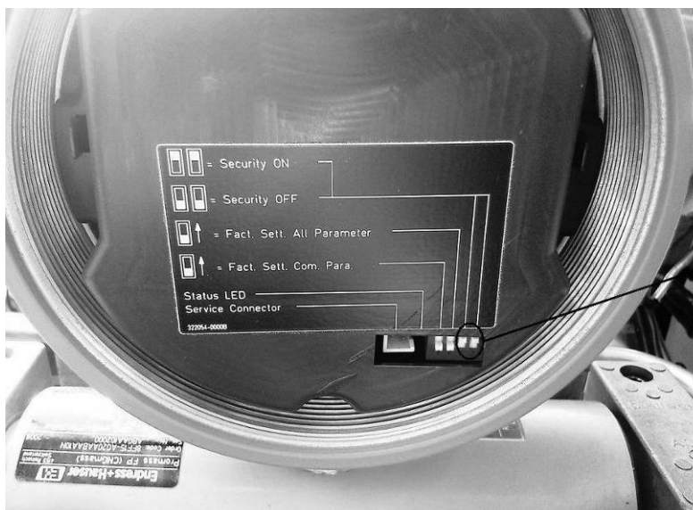
Obr. č. 11 Umiestnenie prepínačov v elektronike meradla
